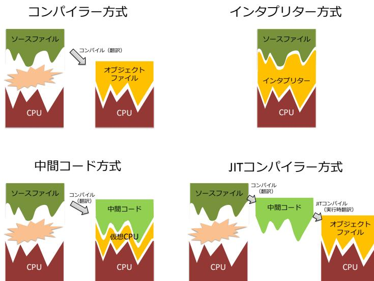
この方法は Java プログラムを直接インターフォーマタで解釈・実行するよりは高速である。しかし、現在では JVM コードをより高速に実行するために **Just-In-Time (JIT)** コンパイラというものを用いて、JVM コードを実行しながら各 CPU の機械語へ翻訳する、という方法を用いる。
