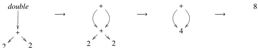
最左戦略は必要になるまで評価を遅らせるので \_\_\_\_\_ ( lazy evaluation ) とも言われる。プログラミング言語で遅延評価を用いる場合は、このようにグラフ簡約と組み合わせて、同じ計算の繰り返しを避けるようになるのが一般的である。
