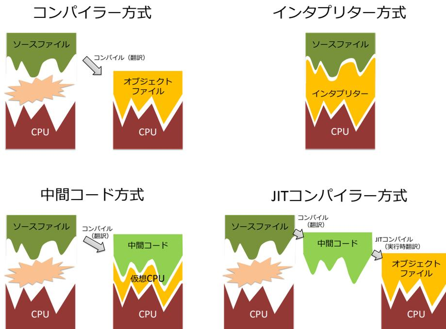
この方法は Java プログラムを直接インタプリタで解釈・実行するよりは高速である。しかし、現在では JVM コードをより高速に実行するために \_\_\_\_\_ というものを用いて、JVM コードを実行しながら各 CPU の機械語へ翻訳する、という方法を用いる。
