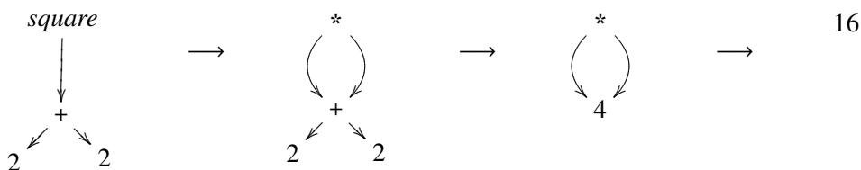
最左戦略は必要になるまで評価を遅らせるので \_\_\_\_\_ ( lazy evaluation )とも言われる。ただし、プログラミング言語で遅延評価を用いる場合は、このようにグラフ簡約と組み合わせて、同じ計算の繰り返しを避けるようにするのが一般的である。
